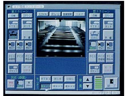
各機器ごとに、あらかじめ予定の作業を組み込んでおくパターン制御も可能
