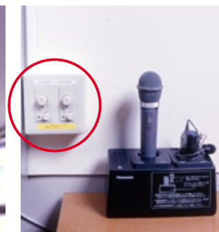
リモートコントロールパネルの右側はタイピン形、左側はスピーチ用マイクロホンの操作をおこなえます
