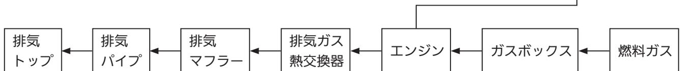
※ガスボックスは機械室と隔離されており、燃料ガスが漏れても機械室内に漏れずに大気に放出します。
