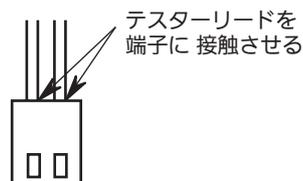
(2) 低圧圧力センサー：デジタル表示部に「E05」が表示されて、コンプレッサーが運転しないとき。
