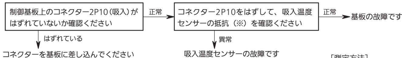
※ 吸入温度が  $-30^{\circ}\text{C} \sim 20^{\circ}\text{C}$  のとき、センサー抵抗値が  $\text{約}2\text{k}\Omega \sim 25\text{k}\Omega$  なら正常です。
