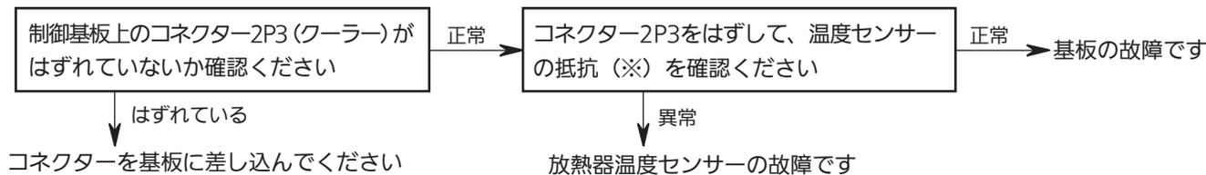
※ 放熱器温度が  $20^{\circ}\text{C} \sim 100^{\circ}\text{C}$  のとき、センサー抵抗値が  $\text{約}3\text{k}\Omega \sim 100\text{k}\Omega$  なら正常です。
