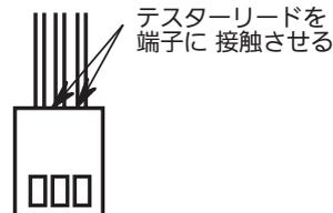
(3) 高圧圧力センサー：デジタル表示部に「E06」が表示されるとき。
