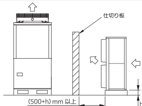
(注) 排気熱が直接上吹冷凍機の熱交換器に吸い込まれないように設置してください。やむをえず設置する場合は、仕切り板などを設けてください。
