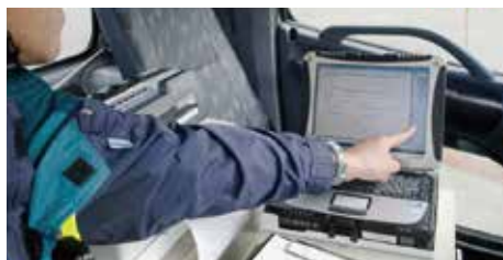
「サービサー」と呼ばれる給油作業車に搭載されたTOUGHBOOK CF-19。3Gデータ通信を通じて給油量などの情報を事務所のサーバーに送信します。
