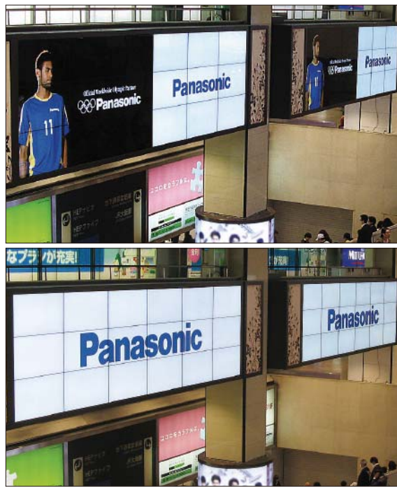
▲「梅田ツインビジョン」での表示例。1基のマルチスクリーンシステムを2画面で使用(上写真)することも、32:9のワイド画面として使用(下写真)することもできる。
