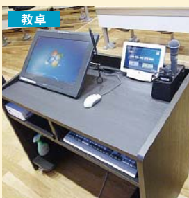
◀操作タブレットとペンタブレットは教卓に設置。システムとはワイヤレスで接続しているため、教卓ごと移動が可能。
