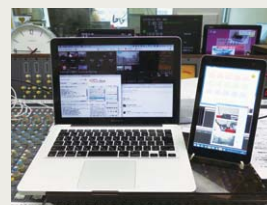
ミキサー卓上のUstream用制御端末。タブレット端末でカメラをコントロール
